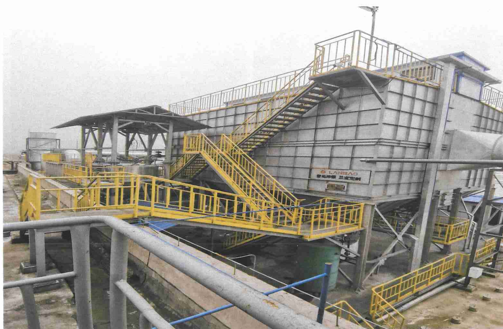
布袋除尘+沸石转轮浓缩吸附+RTO蓄热燃烧氧化系统
